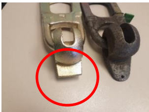
Figuur 4: Hijshaak met korte aanslaglip.
